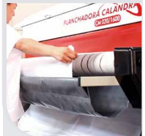
Es muy fácil y cómodo operar las Planchadoras Secadoras Calandras **BARCIA**. Gracias a su simplicidad se puede regular electrónicamente tanto la velocidad de planchado como la temperatura. La posibilidad de ajustar a voluntad ambos parámetros, permite adaptar el equipo a la necesidad de cada usuario.
